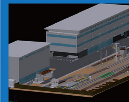
3次元測量をもとに3次元CADで図化 (現場の見える化の一例)
